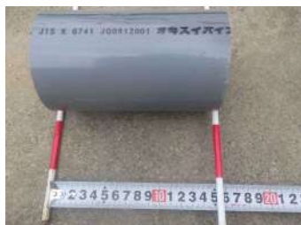
⑤ 止水板 塩ビ管 VP75 L=150 mm
