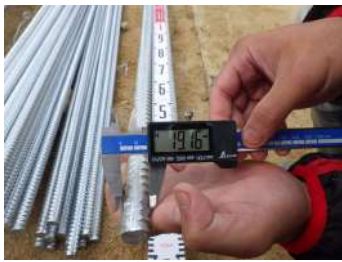
① ネジ節棒鋼 表面処理:HDZ55
