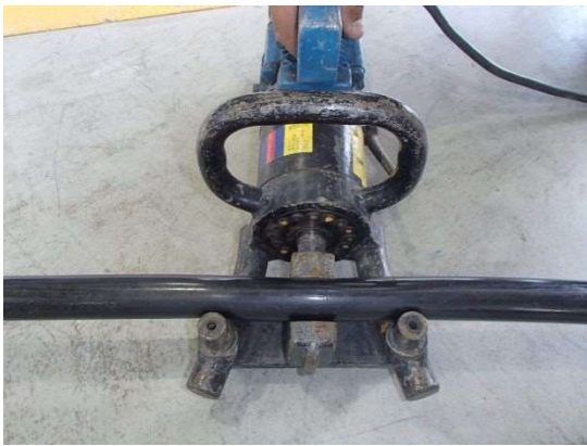
写真-13 D19 鉄筋曲機 況
